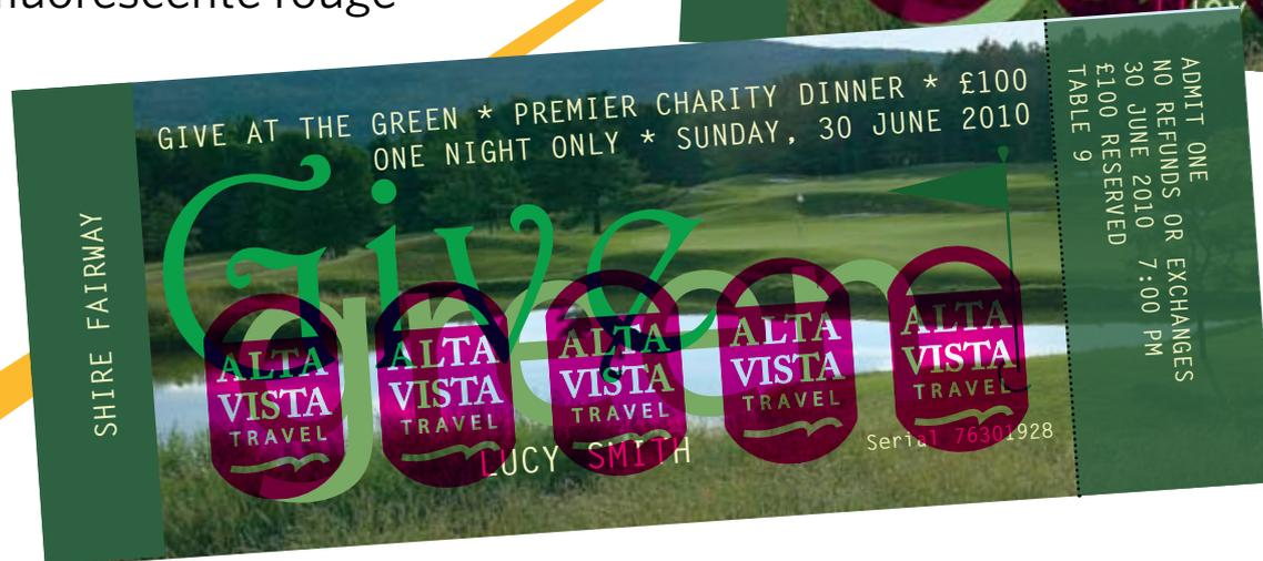
*L'image ci-dessus simule une impression réalisée avec l'encre sèche fluorescente rouge et placée sous un éclairage ultraviolet. Lorsque l'on place l'échantillon ci-contre sous un éclairage ultraviolet, l'encre ressort en rouge fluorescent, faisant apparaître le logo Alta Vista Travel qui authentifie dans cet exemple le document et empêche toute fraude.*
